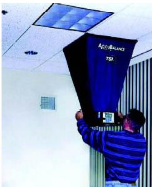
TSI 公司的 ACCUBALANCE 套帽式风量罩可测定流经各种风口（散流器、百叶等）的风量。体积轻巧，仅重 3.5Kg，便于携带使用。把风量罩安放在风口上，就可由数字显示屏直接读出进风或排风量。8380 型号还可以精确的测定温度
